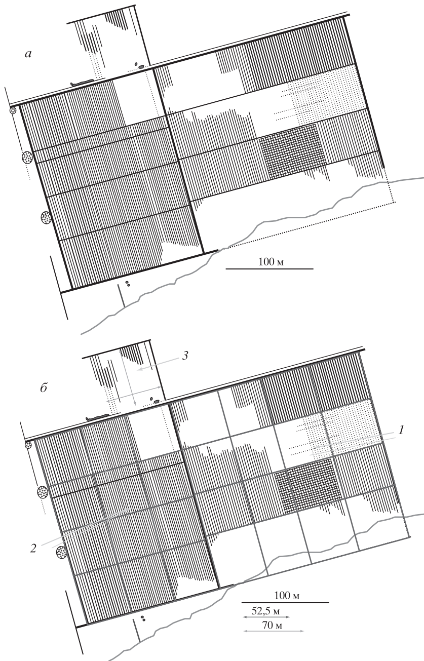
Рис. 7 а-б: а – чертеж надела у мыса Ойрат, построенный по данным магнитной съемки 2011 г.; б – внутреннее деление надела на модули размерами 52, 5 x 52, 5 м, показанное красными линиями. Цифрами отмечены: 1 – восточная и 2 – западная части надела; 3 – северная «пристройка» размерами 70 x 70 м
