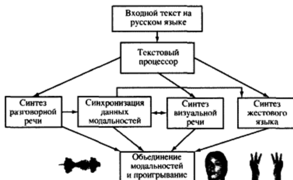
Рис. 6. Архитектура универсальной многомодальной системы синтеза аудиовизуальной разговорной речи и калькирующей жестовой речи
